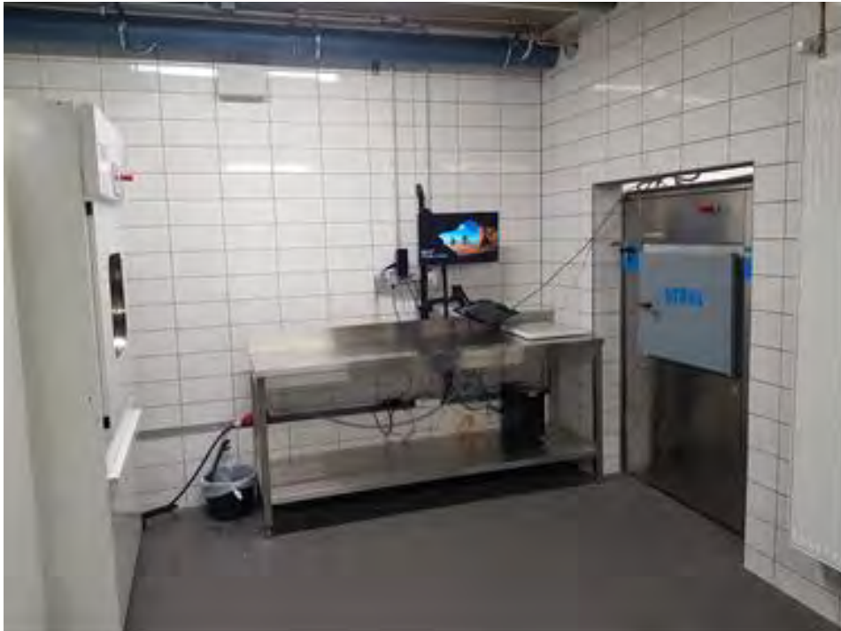
Entnahmebereich der Waschmaschine mit „Scan“-Vorrichtung zur Überwachung der Reinigungs- und Imprägnier-Intervalle jedes einzelnen Wäschestückes.
