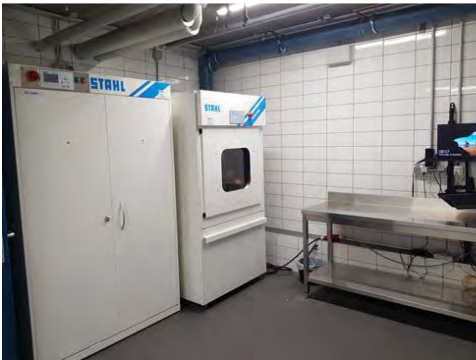
Zur Trocknung stehen nun ein Industrietrockner und ein Trockenschrank zur schonenden Trocknung der schweren Einsatzbekleidung zu Verfügung.
