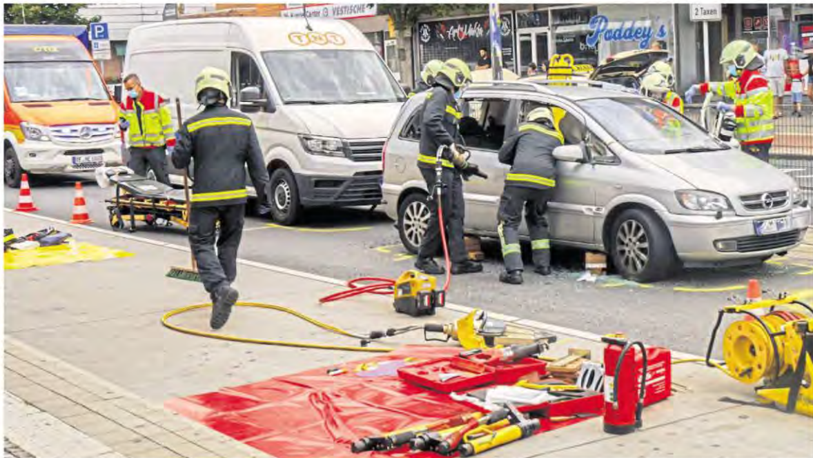
Mit einer Hydraulischschere und einem Spreizer arbeiten sich die Einsatzkräfte der Feuerwehr vor. Zum Schluss wird auch das Dach des Opels entfernt, um die Frau schonend aus dem Auto holen zu können. —FOTOS: MAISS
