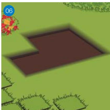
06 Die Sohle ist eben und gleichmäßig – jetzt beginnt der neue Aufbau. Bringen Sie wie oben geschildert etwa 5–10 cm Oberboden auf der Muldensohle aus. Auch dieser Boden wird möglichst eben verteilt.
