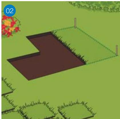
02 Tragen Sie von der zukünftigen Muldenfläche den Rasen ab. Wenn er wieder eingebaut werden soll: stechen Sie gleichmäßige Stücke ab und lagern diese seitlich mit der Rasenseite nach oben. Wenn er länger als zwei Tage gelagert werden muss, müssen Sie dafür sorgen, dass Licht, Luft und Wasser an die Oberseite der Rasensoden gelangt, damit sie später wieder angehen.
