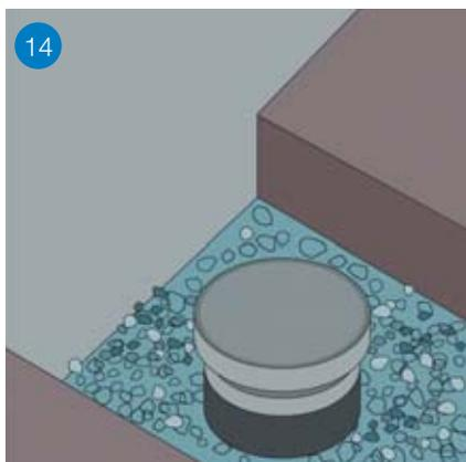
14 ... und mit einem Stutzen dicht verschlossen, damit keine Erde in die Kanalisation gelangen kann. Anschließend wird das Loch verfüllt (zum Beispiel mit überschüssigem Boden aus der Rigole).
