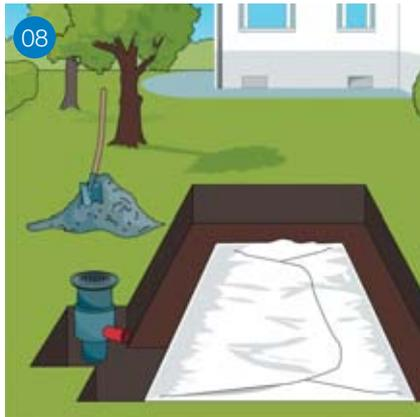
**08** Sie sollten einen direkten Überlauf aus der Mulde in die Rigole ermöglichen. Dazu können Sie den Anschluss jetzt herstellen. Hierzu sind einfache PVC-Rohre oder Dränrohre und ein Sicker-Filter-schacht aus dem Baumarkt bestens geeignet. Halten Sie sich beim Einbau des Sicker-Filter-schachtes genau an die Angaben des jeweiligen Herstellers.
