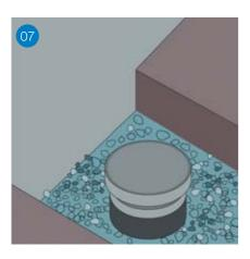
07 ... und mit einem Stutzen dicht verschlossen, damit keine Erde in die Kanalisation gelangen kann. Anschließend wird das Loch verfüllt.
