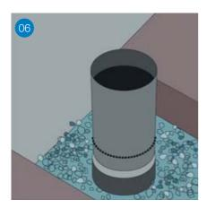
06 Das Standrohr wird ein Stück unter der Erdoberfläche abgetrennt ...
