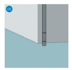
Jetzt ist es an der Zeit, den alten Anschluss des Fallrohres an die Kanalisation in Ruhestand zu schicken: Durchtrennen Sie das Regenfallrohr soweit oberhalb des Bodens, dass Sie das neue Krümmerstück ansetzen können. Meist geht das am besten, indem man das Standrohr durchtrennt und nach unten vom Fallrohr abzieht.
