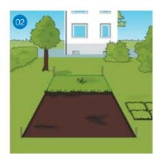
02 Tragen Sie dazu in den hochliegenden Bereichen der künftigen Versickerungsfläche Boden ab, den Sie zum Teil in tiefer liegenden Bereichen wieder aufbringen können.
