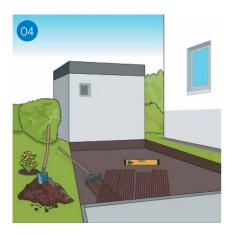
Tauschen Sie den Untergrund aus, wenn dieser verdichtet oder nicht für die Versickerung geeignet ist. Handelt es sich um weitgehend natürliche, körnige Erdmaterialien, kann das Auflockern genügen. Die Bearbeitung des Untergrundes entscheidet über das Gedeihen der Pflanzen, die Sie später darüber setzen, ebenso wie über die Wasserdurchlässigkeit.
