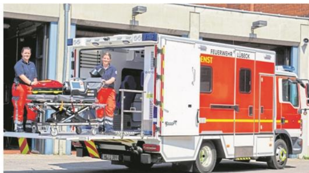
In Lübeck ist bereits seit mehr als zwei Jahren ein Schwerlast-Rettungswagen mit Hebebühne im Einsatz. Die Basis bildet ein 7,5-Tonnen-Lkw-Fahrgestell. —FOTO: DPA
