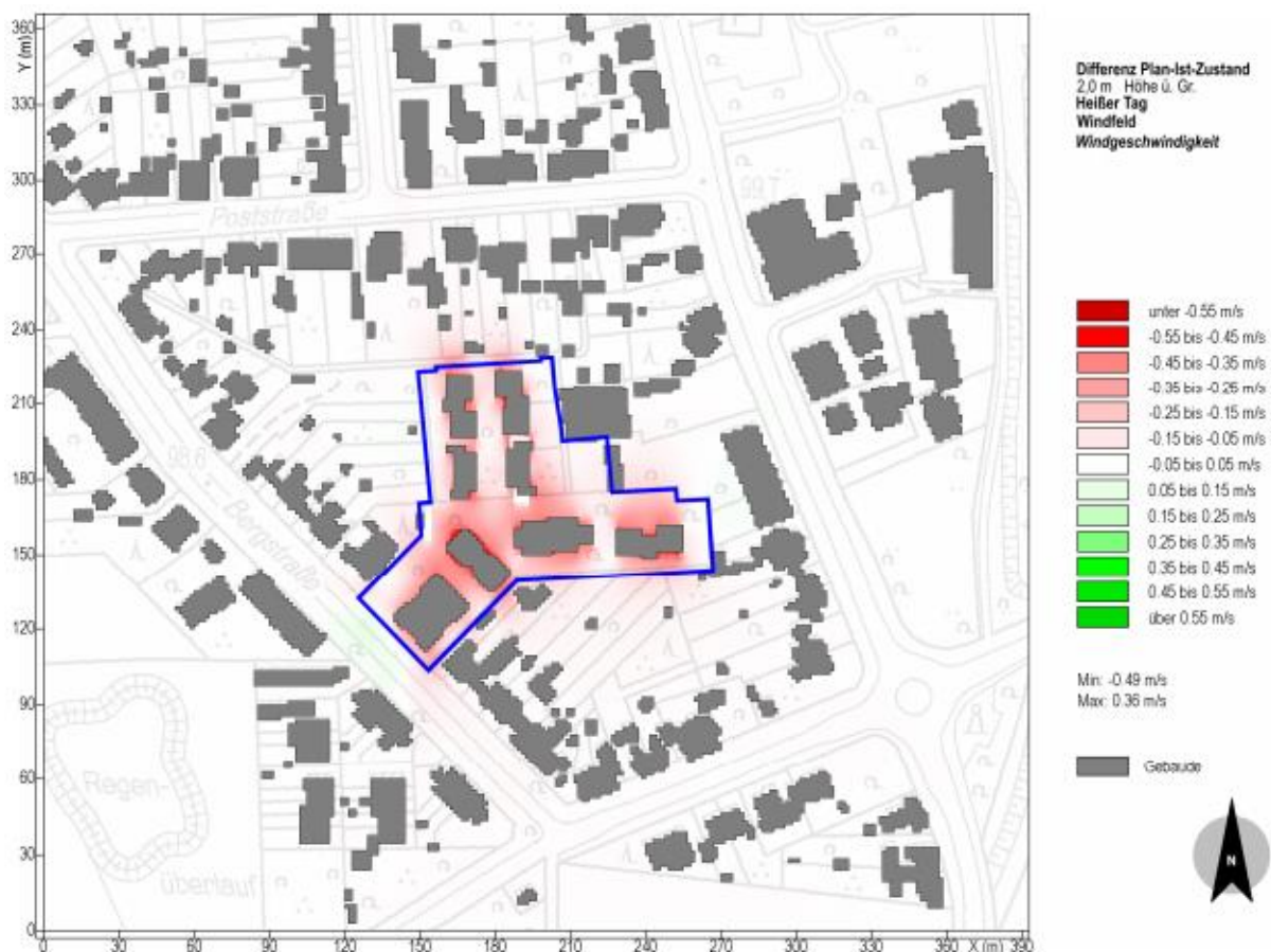
Abbildung 5-8: Differenzen der Windgeschwindigkeit in 2 m ü. Gr. eines heißen Tages zwischen Plan- und Ist-Zustand (Quelle: Bericht Dr. Düttemeyer)
