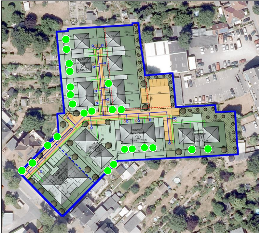
Abbildung 5-11: Empfehlungen für Baumpflanzungen (grüne Punkte) gegen Gebäudeaufheizung und Hitzeprävention im Außenbereich für den Planentwurf des Quartiers Bergstraße in Herten (Quelle: Bericht Dr. Düttemeyer)
